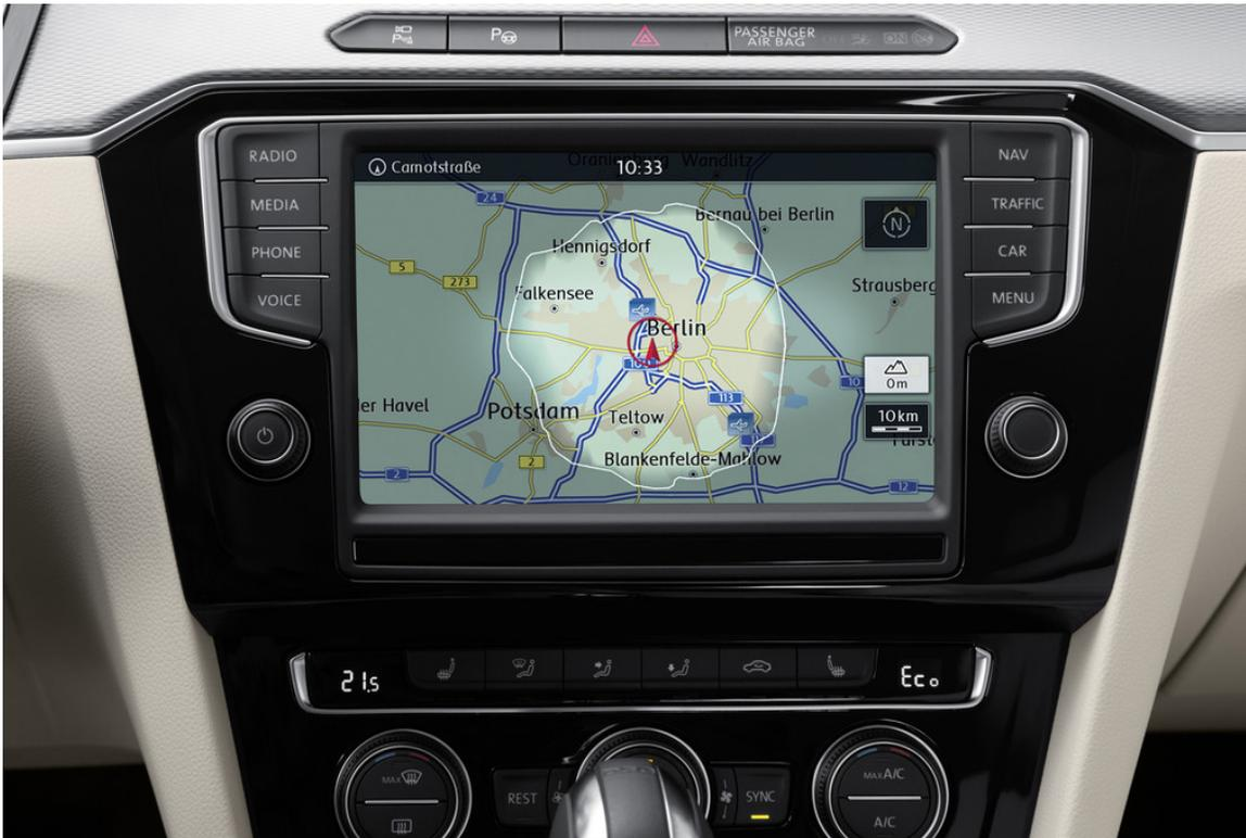
Volkswagen Passat GTE: Das Navigationssystem zeigt den Reichweitenradius für die noch verbliebene Batterieladung an.
