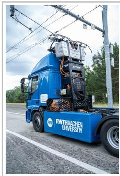
PEM-Projekt der RWTH Aachen demonstriert fahrtaugliche Elektro-Lkw mit Oberleitungsstromabnehmer (Pantographensystem).
