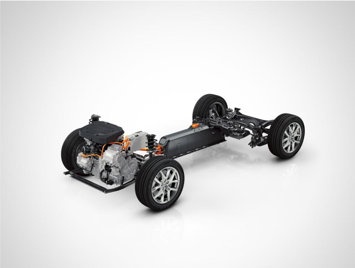
Volvo-Hybridantrieb T5 Twin Engine auf der kompakten Modular-Architektur (CMA).
