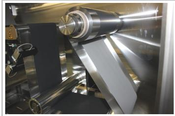
Wichtigster Bestandteil der Embatt-Batterie ist die Bipolar-Elektrode – eine metallische Folie, die mit keramischen Speichermaterialien beidseitig beschichtet wird.
