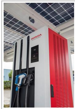
Honda betreibt in Offenbach eine öffentliche Ladesäule mit 940-V-Hochvolttechnologie, an der gleichzeitig bis zu vier Fahrzeuge mit unterschiedlichen Steckertypen aufgeladen werden können.
