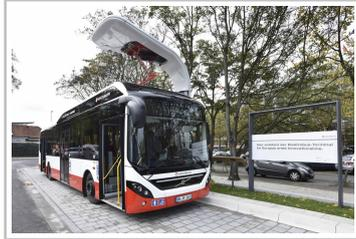
Die Hamburger Hochbahn setzt ab Dezember 2014 drei Volvo 7900 Electric Hybrid auf der Innovationslinie 109 ein. Die Fahrzeuge beziehen ihren Strom jedoch nicht aus der Oberleitung, sondern werden an speziellen Schnell-Lade-Terminals wieder aufgeladen.
