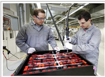
Lithiumionen-Batterie von SB LiMotive: Montage einer Lithiumionen-Batterie am Standort Feuerbach.
