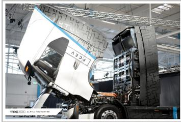
Prototyp des Brennstoffzellen-Lkw Nikola Tre FCEV.
